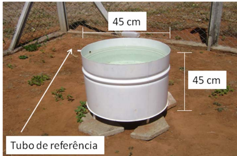
Figura 1 - Tanque Evaporimétrico Alternativo (TEA).
